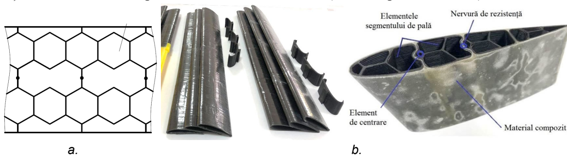
Fig. 11. Unități celulare utilizate pentru fabricarea palelor aerodinamice prin printare 3D (a). Pale și segmente de pale fabricate prin printare 3D (b).
