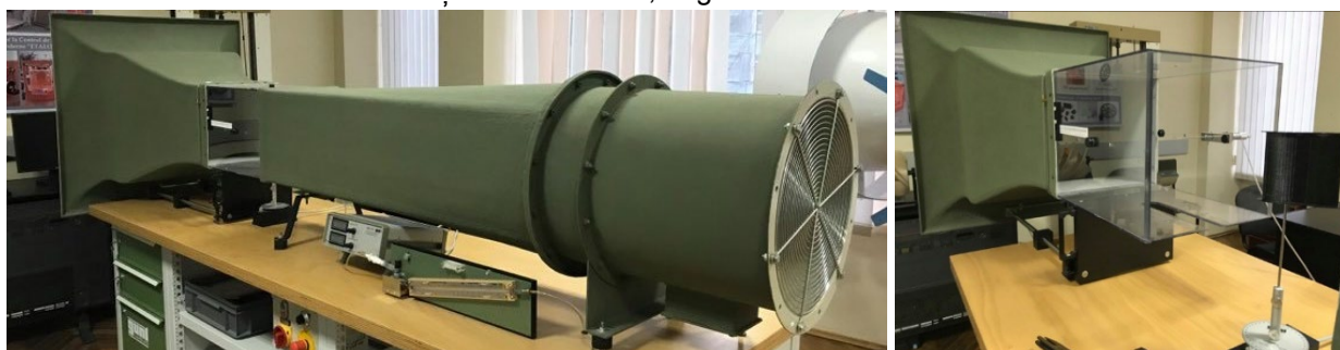
Fig. 5. Testarea segmentelor de pale aerodinamice în tunelul de vânt Gunt HM 170.
