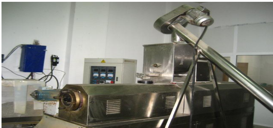
Figura 6. Extruder cu două șnecuri a firmei „Jenan Dairin Machinery Co. LTD”
