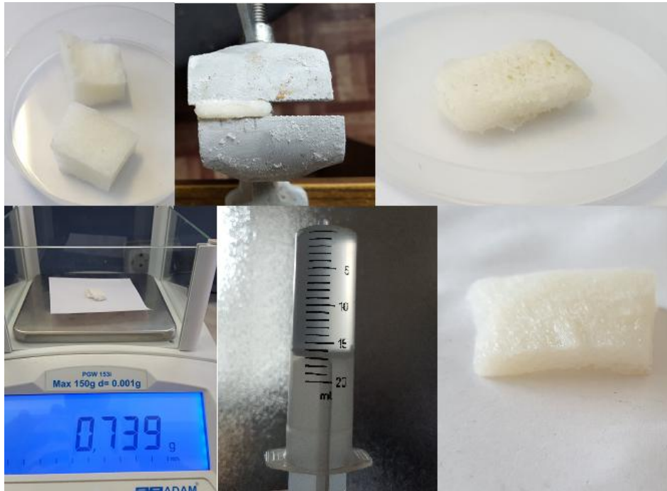
Figura 8. Determinarea gradului de umflare și de expandare a osului demineralizat.
