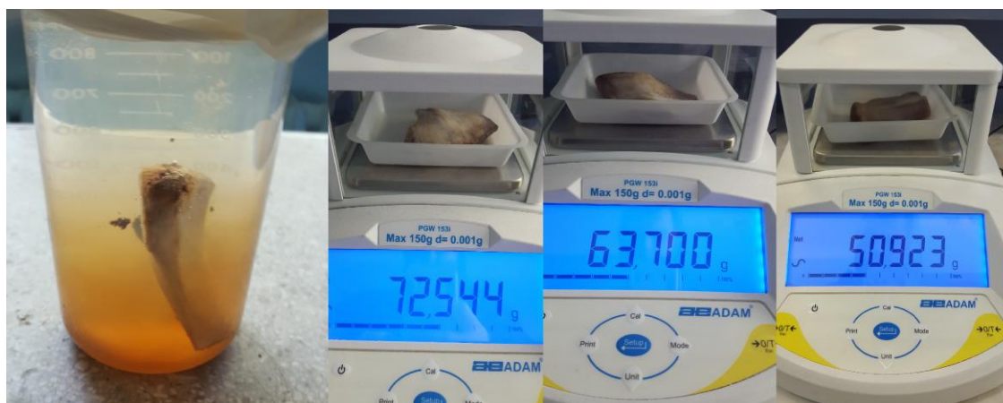
Figura 4. Demineralizarea țesutului osos, 24, 48 și 96 ore.
