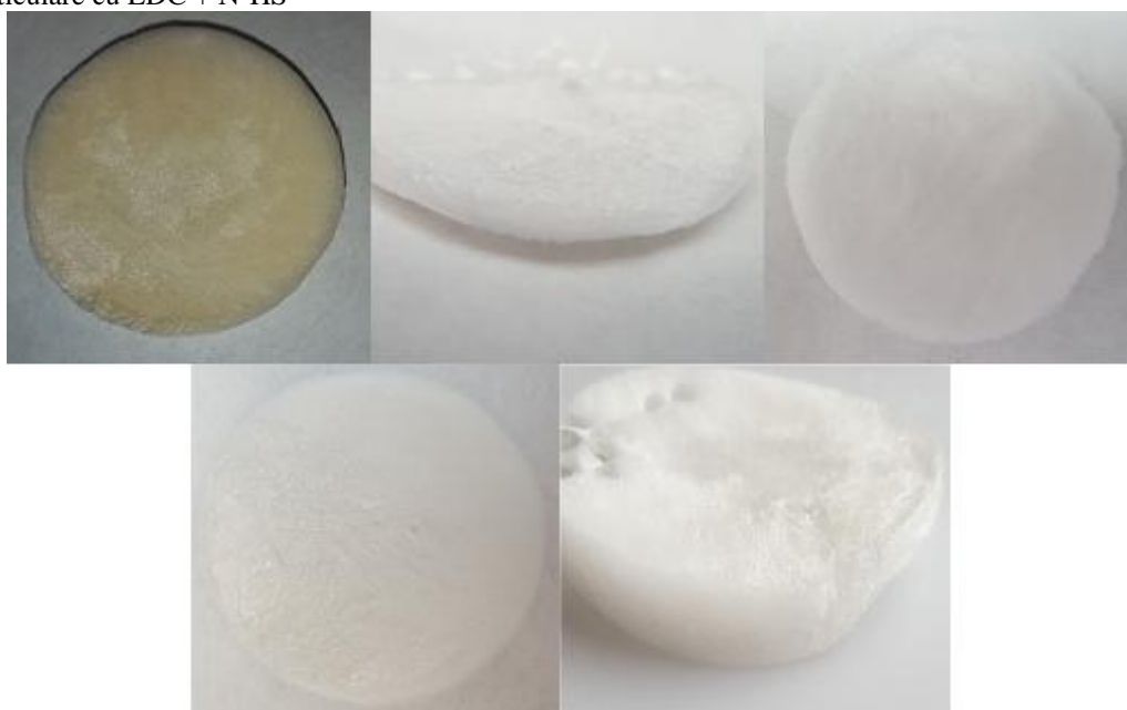
Figura 16. Spongiile reticulate cu: glutaraldehidă, TPP, EDC+N-HS, DHT 120^{\circ}\text{C} și riboflavină
